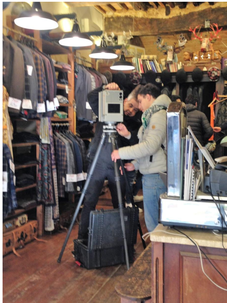
Rilievo all'interno di un negozio
