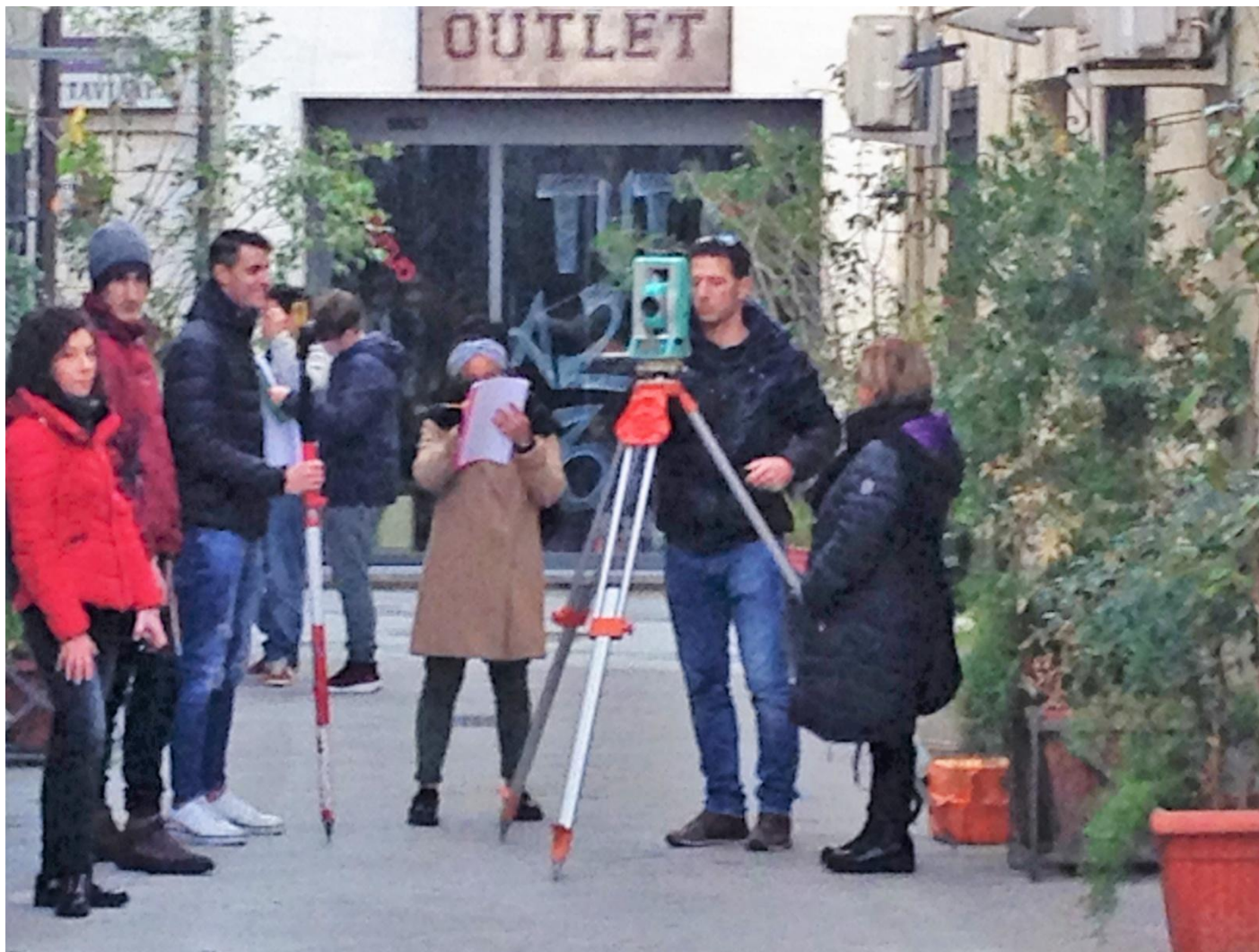
Punto di stazione 100: operazione di collimazione dei punti sulla Via G. Galilei
